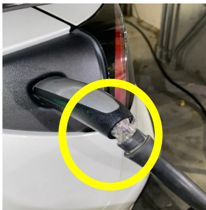
Ilustración 6 Cable de carga de VE con desperfecto.
