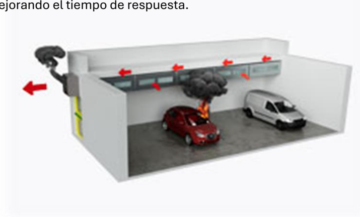
Ilustración 14. Sistema de extracción de humos
