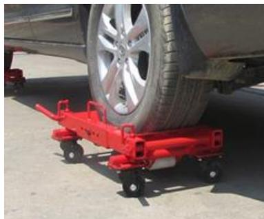
*Ilustración 10 Patines para desplazamiento vehículos en el aparcamiento*
