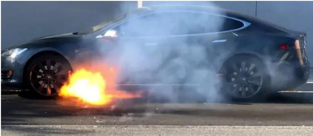
*Ilustración 3 Efecto "Jet Flame" durante incendio de VE.*
