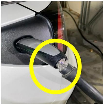
Ilustración 5 Cable de carga de VE con desperfecto.
