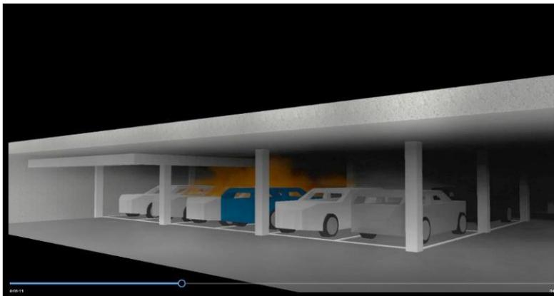
Ilustración 1 Simulación computacional de incendio de VE en aparcamiento sin medidas de protección contra incendios
