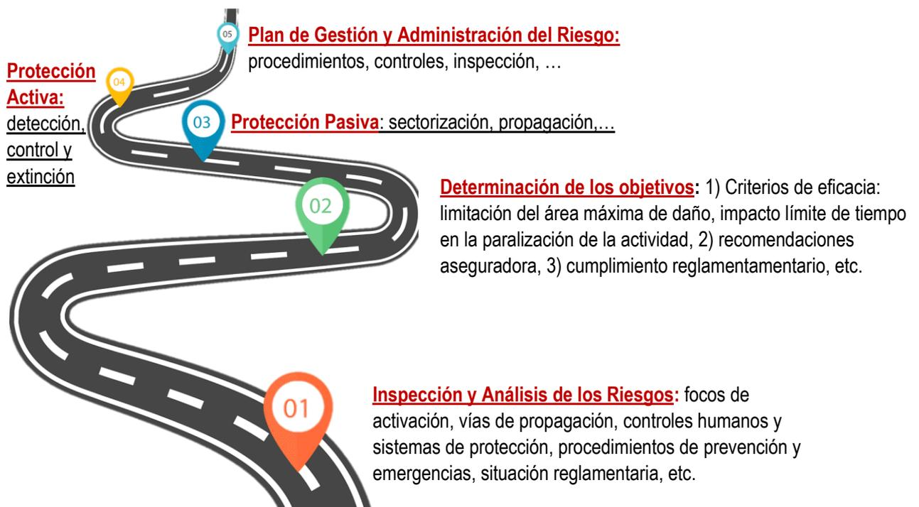
Figura 2: Hoja de ruta del diseño de la seguridad contra incendios
