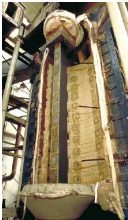
Figura 3. Banco de ensayo de elementos estructurales a compresión
